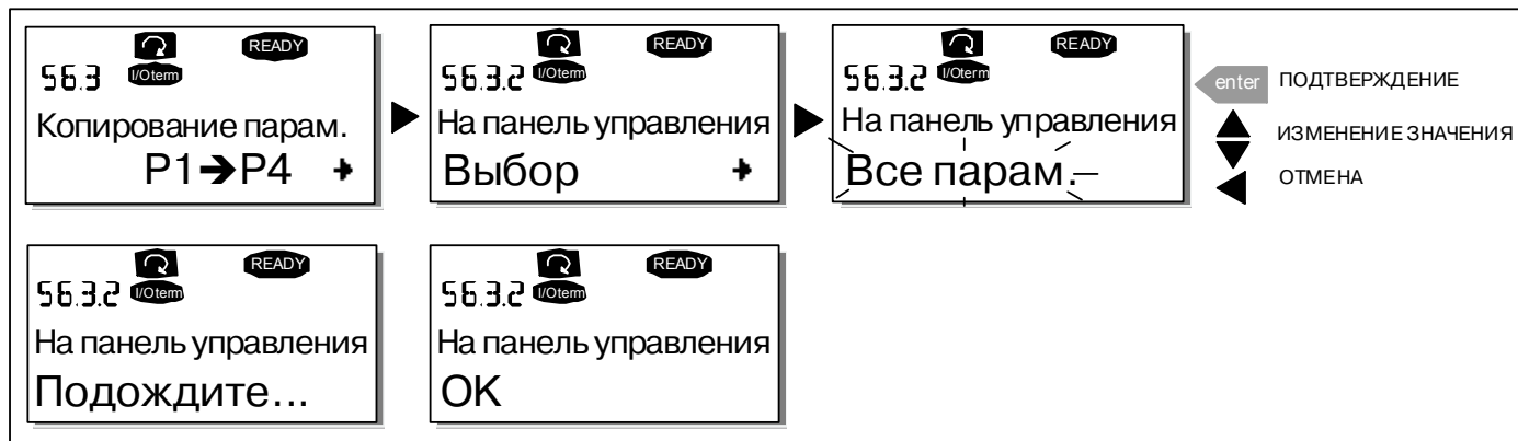
Рисунок 7-12. Копирование параметров в панель управления
