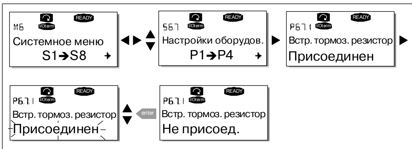
Рисунок 7-21. Подключение встроенного тормозного резистора
